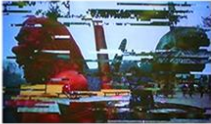
デジタル混信の障害画面（例）
